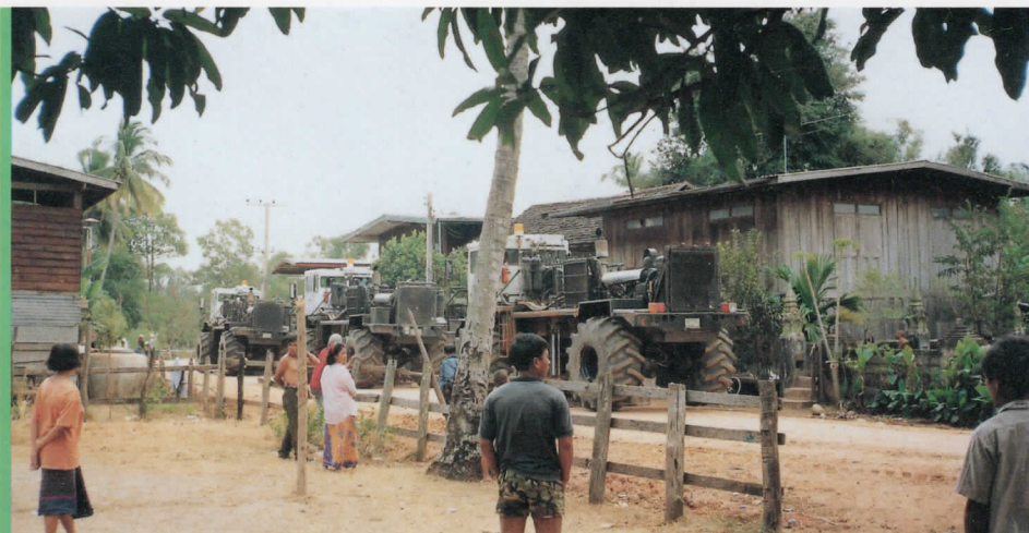
รถสร้างคลื่นสั่นสะเทือน ขณะปฏิบัติงานสำรวจที่หมู่บ้านเมืองแก้ว อำเภอขามุนาม จังหวัดอุบลราชธานี
